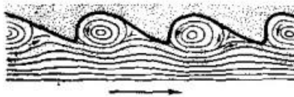
Fig. 82. Formación de las ondas en la arena de la playa por la acción de los remolinos del agua.
