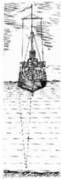
Fig. 153. Esquema del funcionamiento de la sonda de eco
