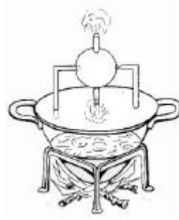
Fig. 8. La máquina (turbina) de vapor más antigua, llamada "eolípila", que se atribuye a Herón de Alejandría.
