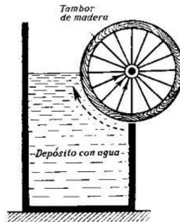
Fig. 57. Otro proyecto de móvil "perpetuo" hidráulico.
