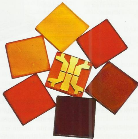
LOS VARIADOS COLORES de las películas de perovskita permiten usarlas para tintar ventanas y paredes al mismo tiempo que generan electricidad.
