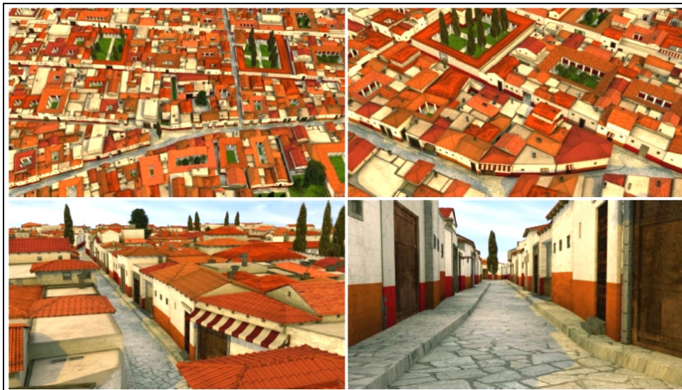
Figura 10 – Simulación de Pompeya con CityEngine®, basado en un sistema-L de unas pocas docenas de reglas
